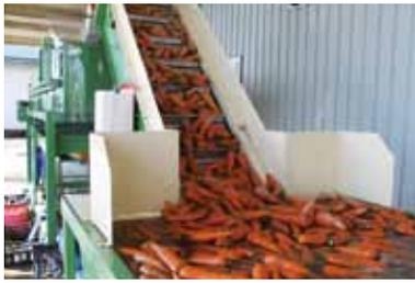
(1) 管内で収穫されたにんじりを洗浄選別機へ運び、「泥付きのまま」で水槽に搬入します。まず大まかな泥を落とし、洗浄区画へ流します。
